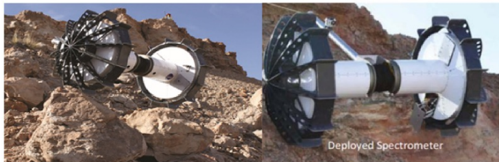
Fig. 12. A) DS probe 'Donut' prototype. B) DS probe 'Sandwich' prototype.
